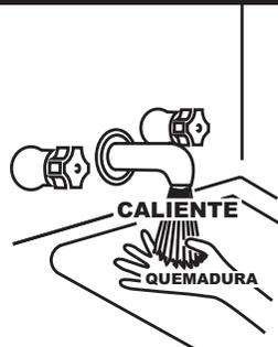
El agua calentada a una temperatura que permita lavar ropa, vajilla y otras necesidades de desinfección puede provocar escaldaduras y daños permanentes al contacto. Los ciclos de calentamiento cortos y repetidos provocados por el uso de poca agua caliente pueden provocar que las temperaturas en el punto de uso superen la configuración de temperatura del calentador de agua en hasta 11 °C (20 °F).
